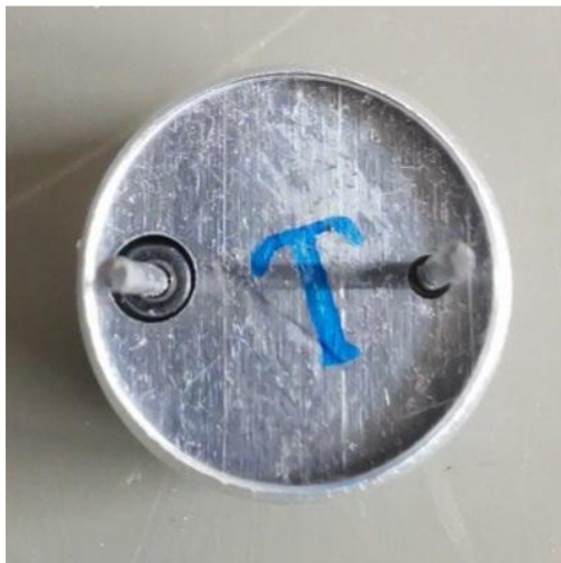
Abbildung 4: Ultraschalllautsprecher; der linke Pin mit dem großen schwarzen Ring ist der + Anschluss (links), fertiger Aufbau (rechts).
